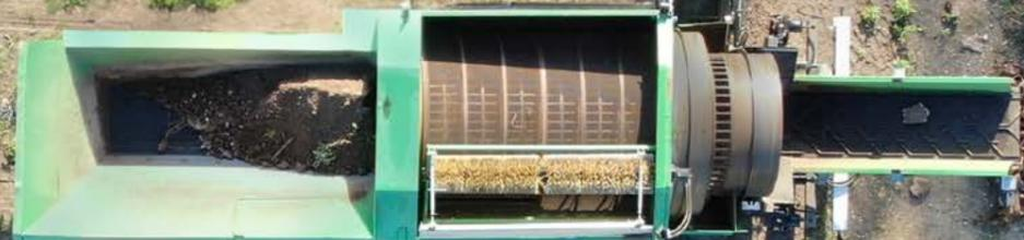
Verlängerte Bänder ermöglichen mehr Flexibilität und können mit einem Trommelmagneten ausgestattet werden.
